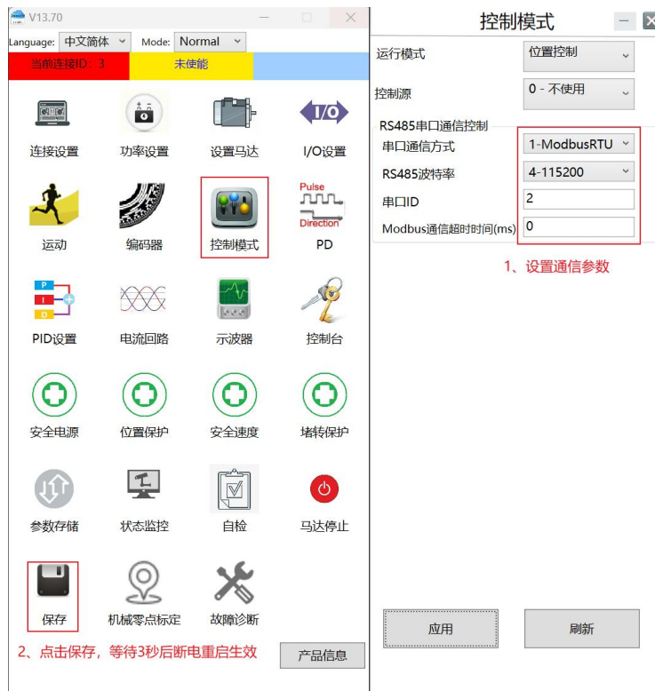
图 3-1 上位机设置 Modbus-RTU 通信参数
